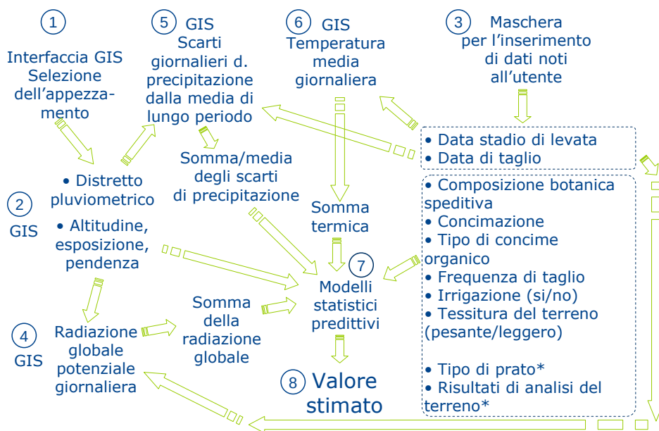
Figura 2 – Diagramma di flusso dell'applicazione web. Solamente i passi 1 e 3 richiedono l'inserimento di informazioni da parte dell'utente.
